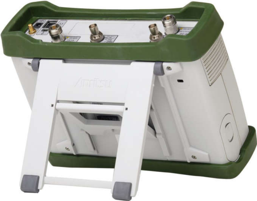
倾斜式拉环集成在外壳和软外壳内，以便获得更好的屏幕视图
