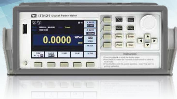
IT9100系列功率分析仪提供1000Vrms和50Arms的最大输入,以及100KHz的测量带宽,可以方便地进行电压、电流、功率、频率、谐波等参数的量测。标配有USB、RS232和以太网通信接口,您可以通过这些接口实现对IT9100系列功率分析仪的远程控制,同时您还可以利用USB外围设备接口,直接将量测参数保存到外部储存介质中。IT9100系列功率分析仪具有0.1%的电压、电流精度,同时还具有丰富的有功功率积分功能。广泛应用于电机、家用电器、UPS、光伏风电、充电桩等测试领域。
