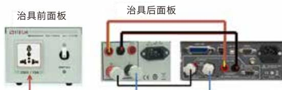
1. 将待测物的输入端接治具点面板三芯插座
