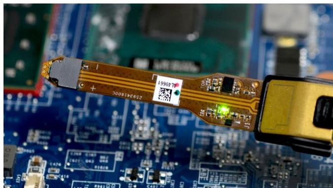
P77STFLXA 焊接柔性电路附件在尖端上有一个有源缓冲放大器。
